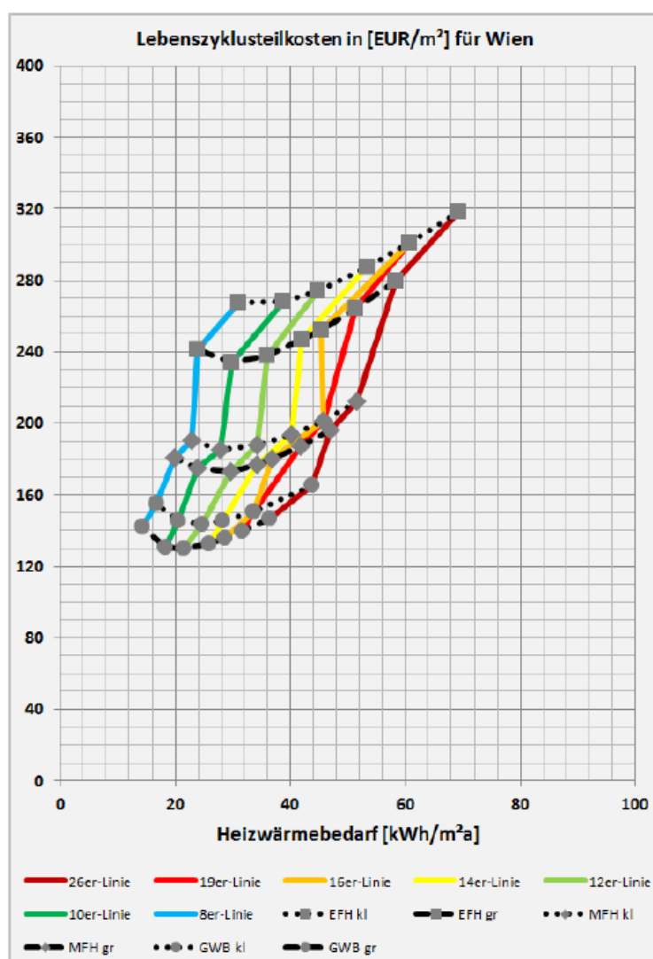
Abbildung 33: Lebenszyklusteilkosten für Wien über dem Heizwärmebedarf
